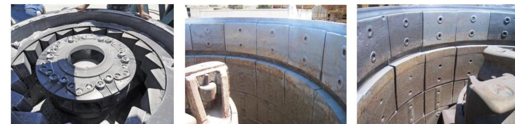
立轴冲击式破碎机(制砂机)配件
